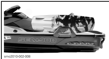
PLANCHE INSTALLÉE ET DÉRIVES ORIENTÉES VERS L'EXTÉRIEUR
