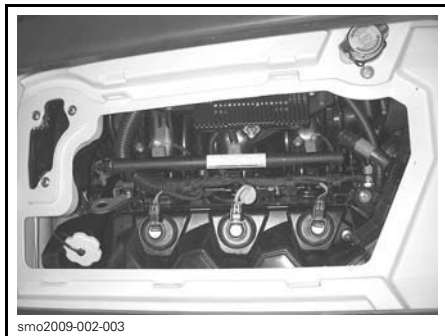
BOÎTE DE VENTILATION RETIRÉE
