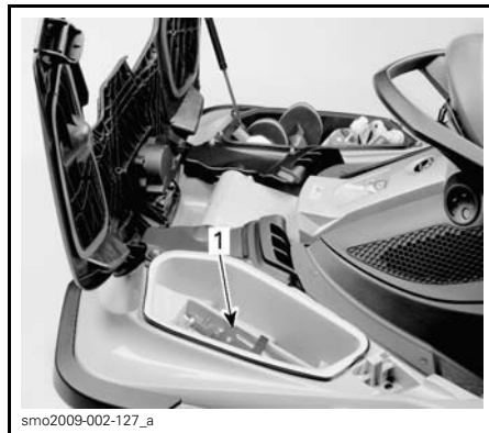
1. Emplacement du support d'extincteur
