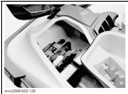
AKUN JA SULAKKEIDEN VAIHTAMINEN - OIKEANPUOLIMAINEN SÄILYTYSLOKERO IRROTETTUNA
