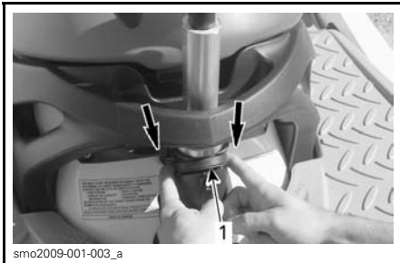
smo2009-001-003_a PAINA KOHTI ETUOSAA VAPAUTTAKSESI JA IRROTTAAKSESI PITIMEN
