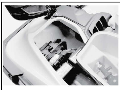
ACCESO A LA BATERÍA Y A LOS FUSIBLES - CONTENEDOR DE ALMACENAMIENTO DERECHO EXTRAÍDO
