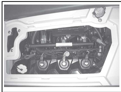
CAJA DE VENTILACIÓN EXTRAÍDA
