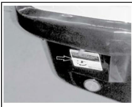
4-TEC™エンジンは、転覆時保護システム(T.O.P.STM)を備えています。ウォータークラフトがひっくり返ると、エンジンは自動的に停止します。
