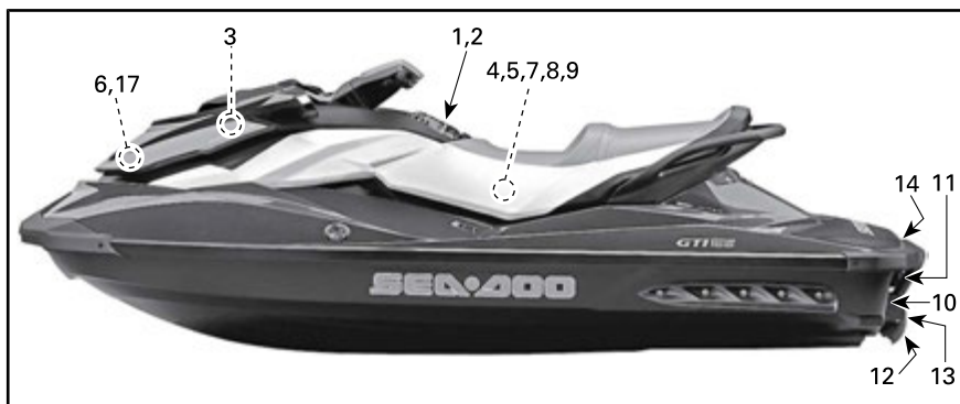
POSIZIONE DELLE ETICHETTE DI SICUREZZA SULLA MOTO D'ACQUA - SERIE GT
