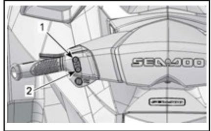
**PULSE EL BOTÓN DE VTS DOS VECES HACIA ARRIBA O HACIA ABAJO PARA UTILIZAR LAS POSICIONES PREDEFINIDAS.**
