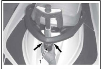
**TÍPICO - EMPUJE HACIA LA PARTE DELANTERA PARA DESBLOQUEAR LA SUJECIÓN Y EXTRAERLA.**
