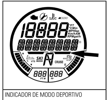
**NOTA:** El modo deportivo no es el modo de pilotaje predeterminado. Para activarlo, es necesario seleccionarlo después de arrancar el motor.
