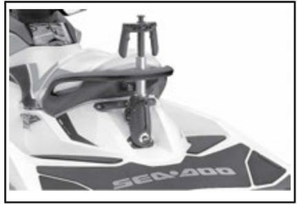
**TÍPICO - SUJECIÓN PARA ESQUÍ/WAKE-BOARD EXTENDIDA**
