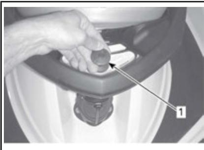
**TÍPICO - SUJECIÓN PARA ESQUÍ/WAKE-BOARD REPLEGADA**
