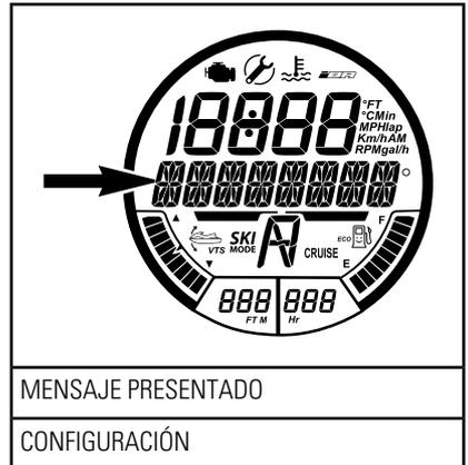
2. Pulse el botón ARRIBA o ABAJO repetidamente hasta que se muestre la función de RELOJ.
