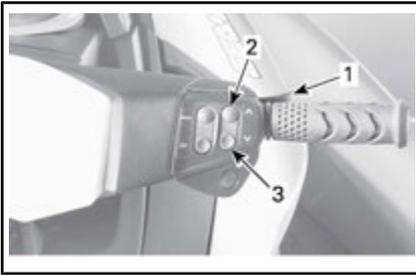
1. Mantenga presionada la palanca del acelerador
