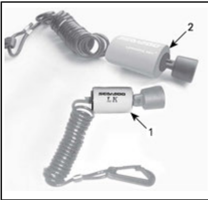
TYPISCH - D.E.S.S. SCHLÜSSEL (HALTEGURTE)
