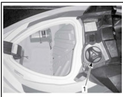
TYPISCH - LAGE DES KRAFTSTOFFTANK-DECKELS
