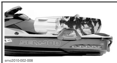
VANNBRETT MONTERT MED FINNENE UTOVER
