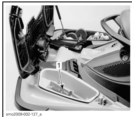
1. Plassering av holder for brannslukningsapparat
