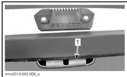
1. Kroken av stativet i den nedre holderen
