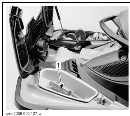
1. Emplacement du support d'extincteur
