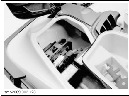
smo2009-002-128 ACCÈS À LA BATTERIE ET AUX FUSIBLES – BAC DE RANGEMENT DROIT ENLEVÉ
