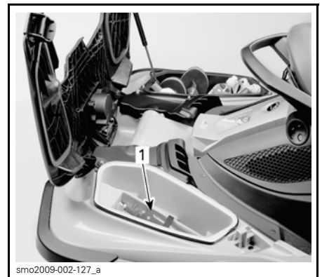
1. Ubicación del soporte para el extintor de incendios
