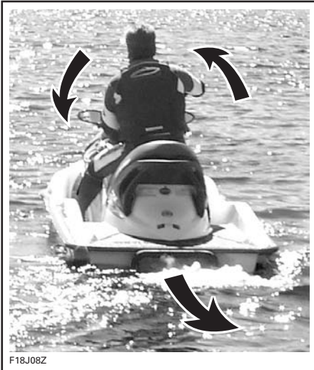
TYPEBILDE - STYRERETNINGEN ER MOTSATT NÅR DU RYGGER
