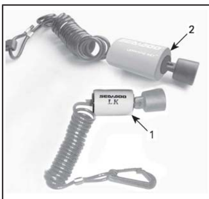
CONFIGURAZIONE TIPICA - CORDINO DI SICUREZZA
