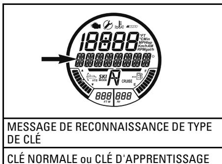
La clé d'apprentissage Sea-Doo limite la vitesse de la motomarine et le couple du moteur. Les conducteurs novices ou peu expérimentés peuvent ainsi apprendre à conduire une motomarine tout en acquérant la confiance et la maîtrise nécessaires.
