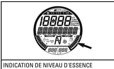
Lorsque le réservoir est plein, 8 segments (barres) de l'indicateur sont allumés. Le segment supérieur n'est pas utilisé.
