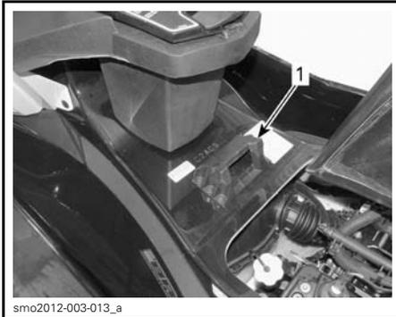
1. Dispositif de retenue avant du siège
