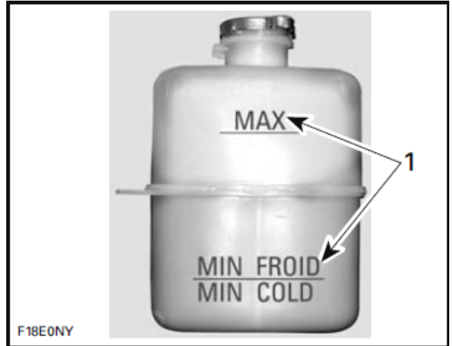
典型图示 - 冷却液胀溢水箱
