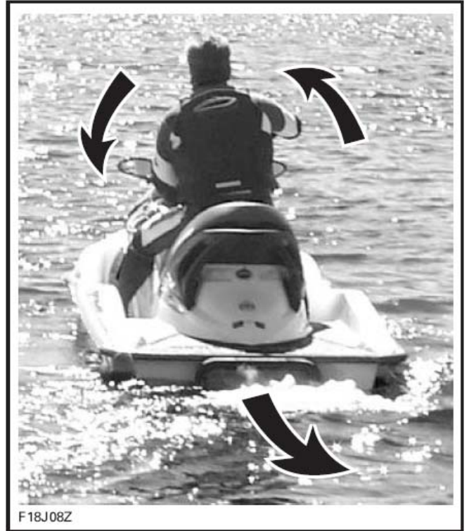
典型图示 – 倒后时转向的方向相反
