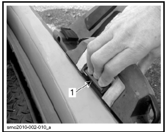
尾波板架拆卸
