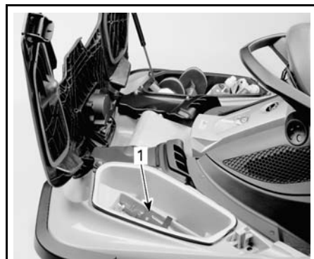
1. Placering av hållare för brandsläckare
