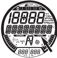
スポーツモードインジケータ (RXT-X/RXT-X aSを除く全モデル)
