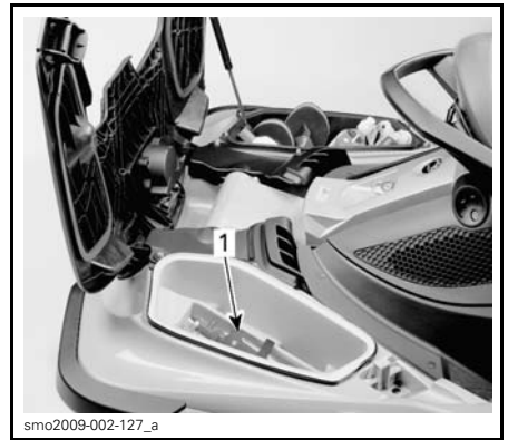
1. Emplacement du support d'extincteur
