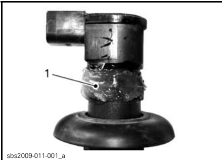
1. Enduit à cet endroit
