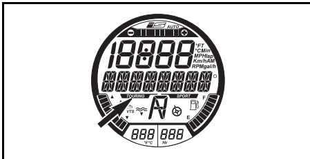
INDICATEUR DE MODE RANDONNÉE (TOUS LES MODÈLES SAUF LES RXT-X/RXT-X aS)
