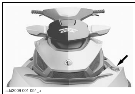
TYPIQUE - EMPLACEMENT DU BOUCHON DU RÉSERVOIR D'ESSENCE
