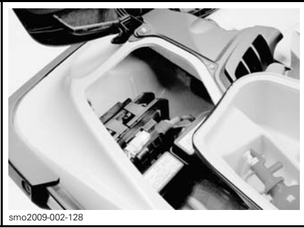
AKUN JA SULAKKEIDEN VAIHTAMINEN - OIKEANPUOLIMAINEN SÄILYTYSLOKERO IRROTETTUNA
