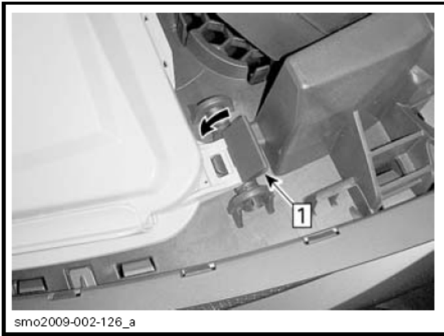
步骤 1: 向下推入锁扣来固定
