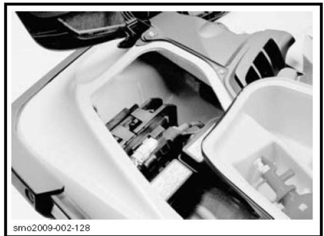
电池和保险丝通道 – 右边储物箱拆除
