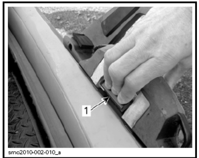
尾波板架拆卸
