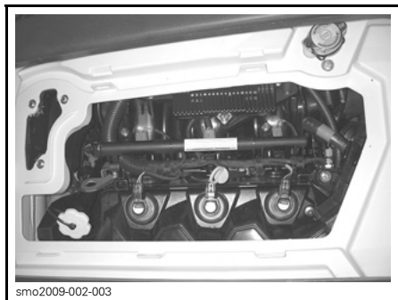
取り外したベンチレーションボックス
