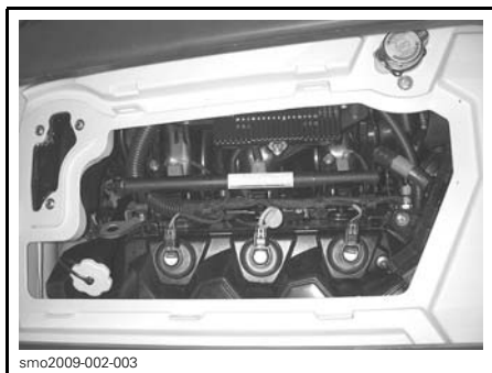
BOÎTE DE VENTILATION RETIRÉE
