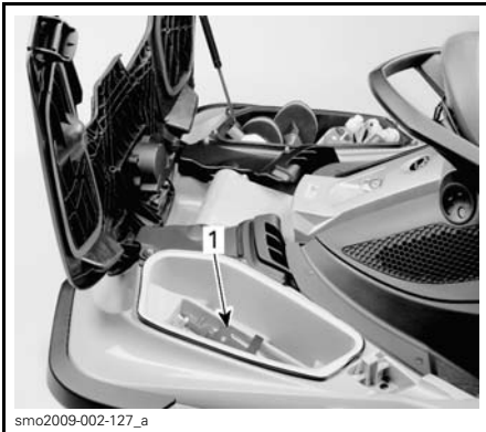
1. Emplacement du support d'extincteur
