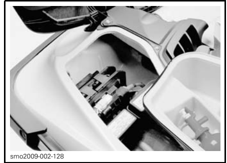
ACCÈS À LA BATTERIE ET AUX FUSIBLES – BAC DE RANGEMENT DROIT ENLEVÉ
