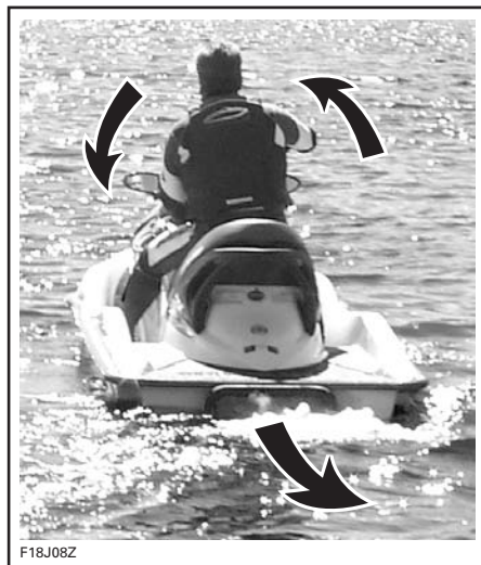
TYPBILD - STYRRIKTNINGEN OMKASTAD VID BACKNING
