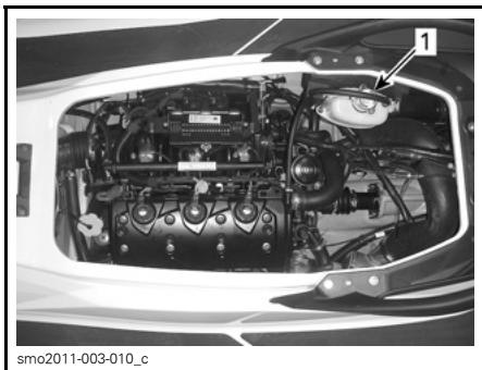
TYPISCH 1. Dop van het expansievat
