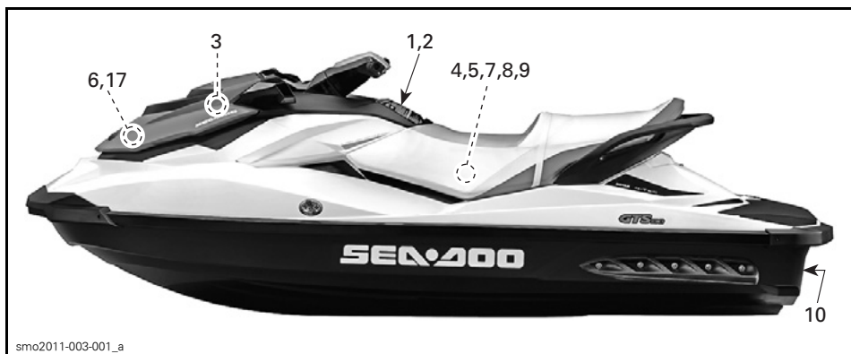
PLAATS VAN HET VEILIGHEIDSLABEL - GTS MODELLEN
