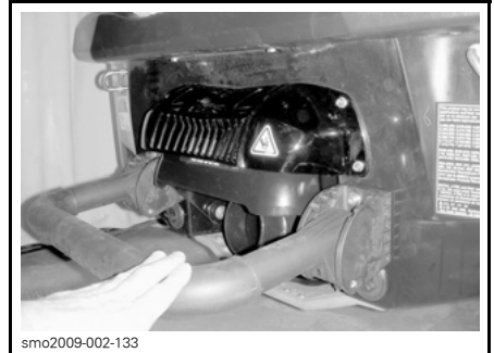
OPSTAPJE NEERGEKLAPT OM VANUIT HET WATER AAN BOORD TE STAPPEN
