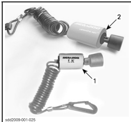
代表的な例 - D.E.S.S.キー(網コード) 1. ラーニングキー、緑色のフロート 2. レンタルキー、オレンジ色のフロート
