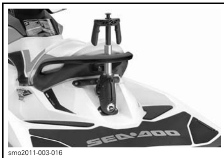
smo2011-003-016 TYPIQUE - POTEAU DE FIXATION DU CÂBLE DE SKI OU PLANCHE NAUTIQUE SORTI
