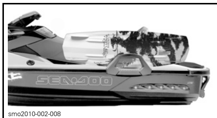
TÍPICO - TABLA DE WAKEBOARD INSTALADA CON LAS ALETAS HACIA FUERA
