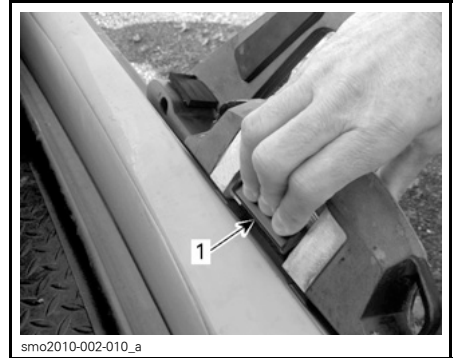
EXTRACCIÓN DEL PORTATABLAS 1. Presione este tirador para liberar el portatablas de wakeboard
