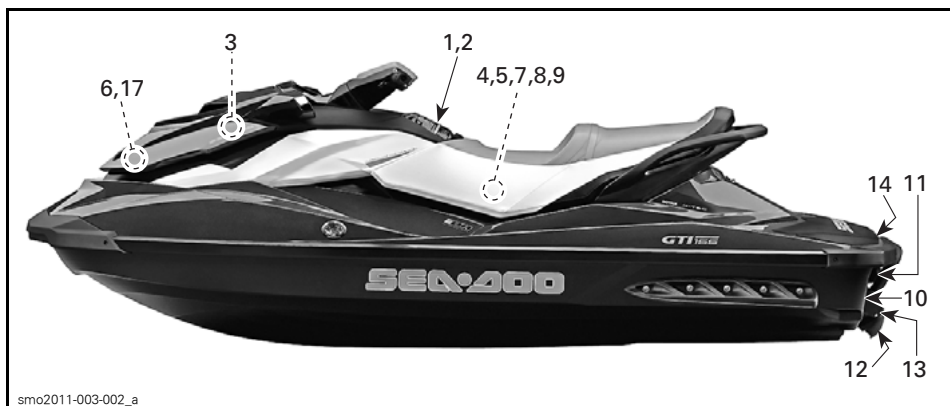
UBICACIÓN DE LAS ETIQUETAS DE SEGURIDAD EN LA MOTO ACUÁTICA - MODELOS GTI
