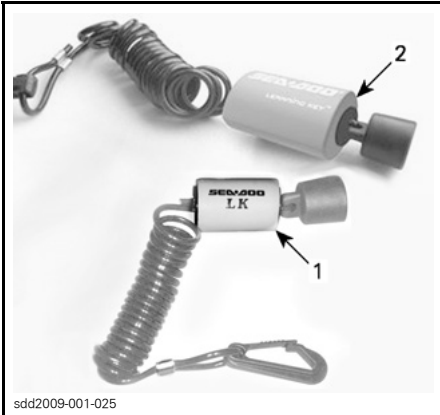
TÍPICO - LLAVES D.E.S.S. (CABLES DE SEGURIDAD)
