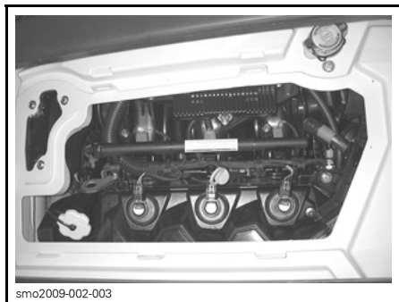
CAJA DE VENTILACIÓN EXTRAÍDA
