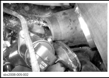
AUS DEM ZWISCHENKÜHLER AUSGETRIEBENES WASSER
