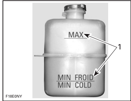
TYPISCH - KOELVLOEISTOFEXPANSIEVAT 1. Peil tussen twee merktekens bij koude motor
