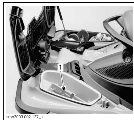
1. Placering av hållare för brandsläckare
