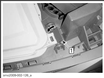
Steg 1: Trykk ned på låsene for å sette fast
