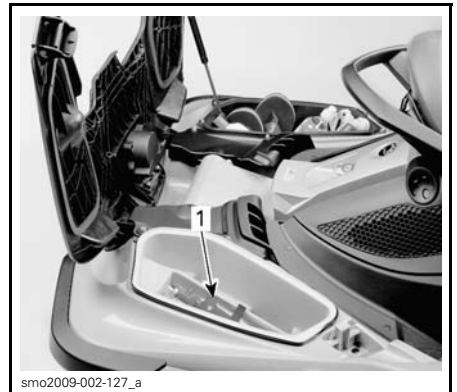
1. Plassering av holder for brannslukningsapparat
