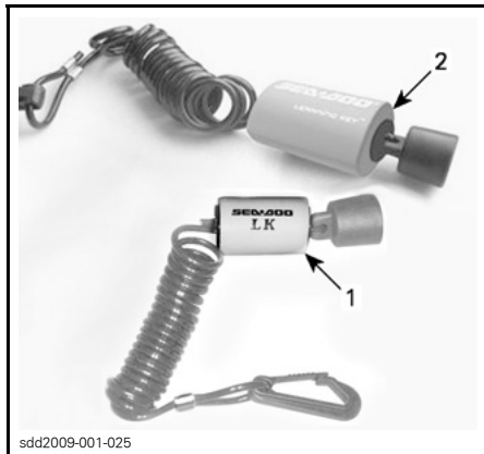
TÍPICO - LLAVES D.E.S.S. (CABLES DE SEGURIDAD)
