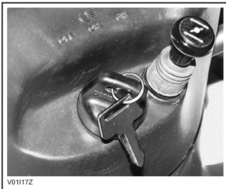
LEVIER D'ÉTRANGLEUR EN POSITION «OFF»
