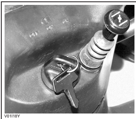
LEVIER D'ÉTRANGLEUR EN POSITION «FULL CHOKE»
