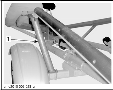
1. Abstützung der begehbaren Fläche
