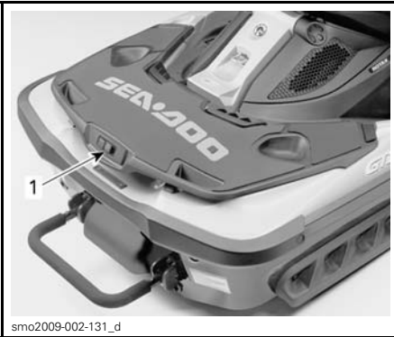
1. Speed-tie -naru takana
