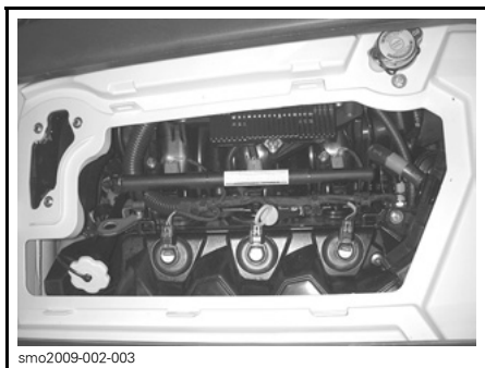
CAJA DE VENTILACIÓN EXTRAÍDA
