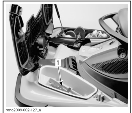
1. Extintor de incendios
