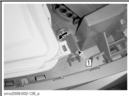
Etapa 1: Presione hacia abajo sobre los seguros para la fijación
