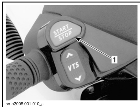
smo2008-001-010_a TÍPICO — TODOS OS MODELOS, EXCETO O PACOTE X 1. Botão de partida/parada do motor
