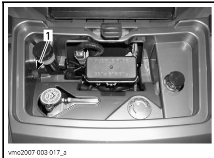
TYYPILLINEN — ETUHUOLTOTILA 1. Kaukosäätimen liitin
