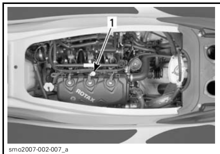
TYPIQUE — TOUTS LES AUTRES MODÈLES 1. Jauge de niveau d'huile
