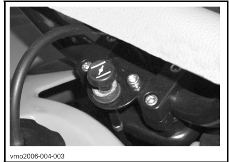
ALAVANCA DO AFOGADOR NA POSIÇÃO OFF
