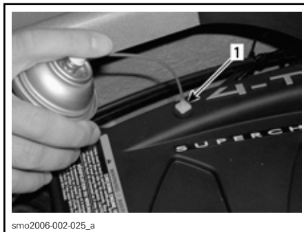
GTI以外の全モデル — エンジンカバー 1. フィットティング
