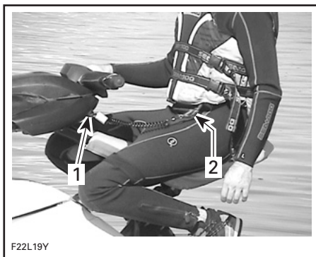
1. Nödstoppslinan monterad på plats 2. Nödstoppslinan säkert fäst i förarens flytväst
