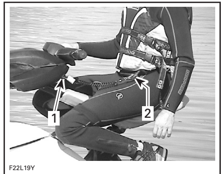
1. Kapje veiligheidskoord in het contact 2. Veiligheidskoord bevestigd aan reddingsvest bestuurder
