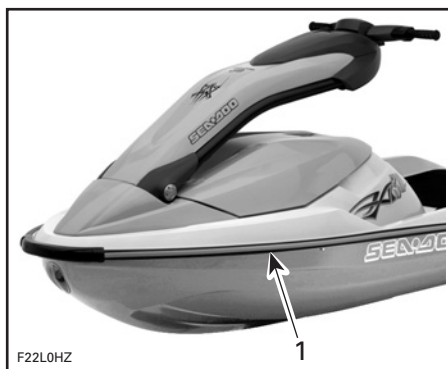
1. Sortie de purge
