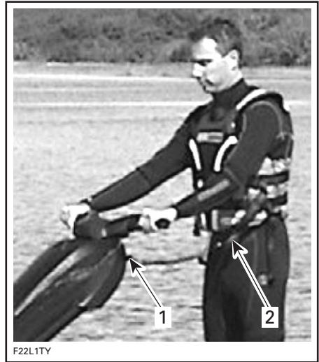
1. Turvanaruliittimen tulppa pitimessään 2. Turvanaruliitin kiinnitettynä kuljettajan henkilökohtaiseen kelluntavälineeseen
