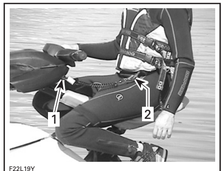
1. Turvanaruliittimen tulppa pitimessään 2. Turvanaruliitin kiinnitettynä kuljettajan henkilökohtaiseen kelluntavälineeseen
