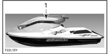
1. Lenksäule hier nach unten verspannen
