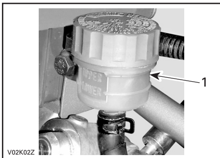
1. Reservatório de fluidos dos freios traseiros
