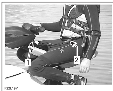
1. Tampão do cordão de segurança na coluna 2. Cordão de segurança amarrado no PFD do operador
